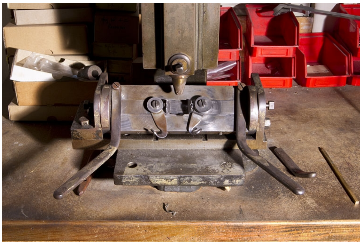
Système de fixation du nez et coulisseau.
