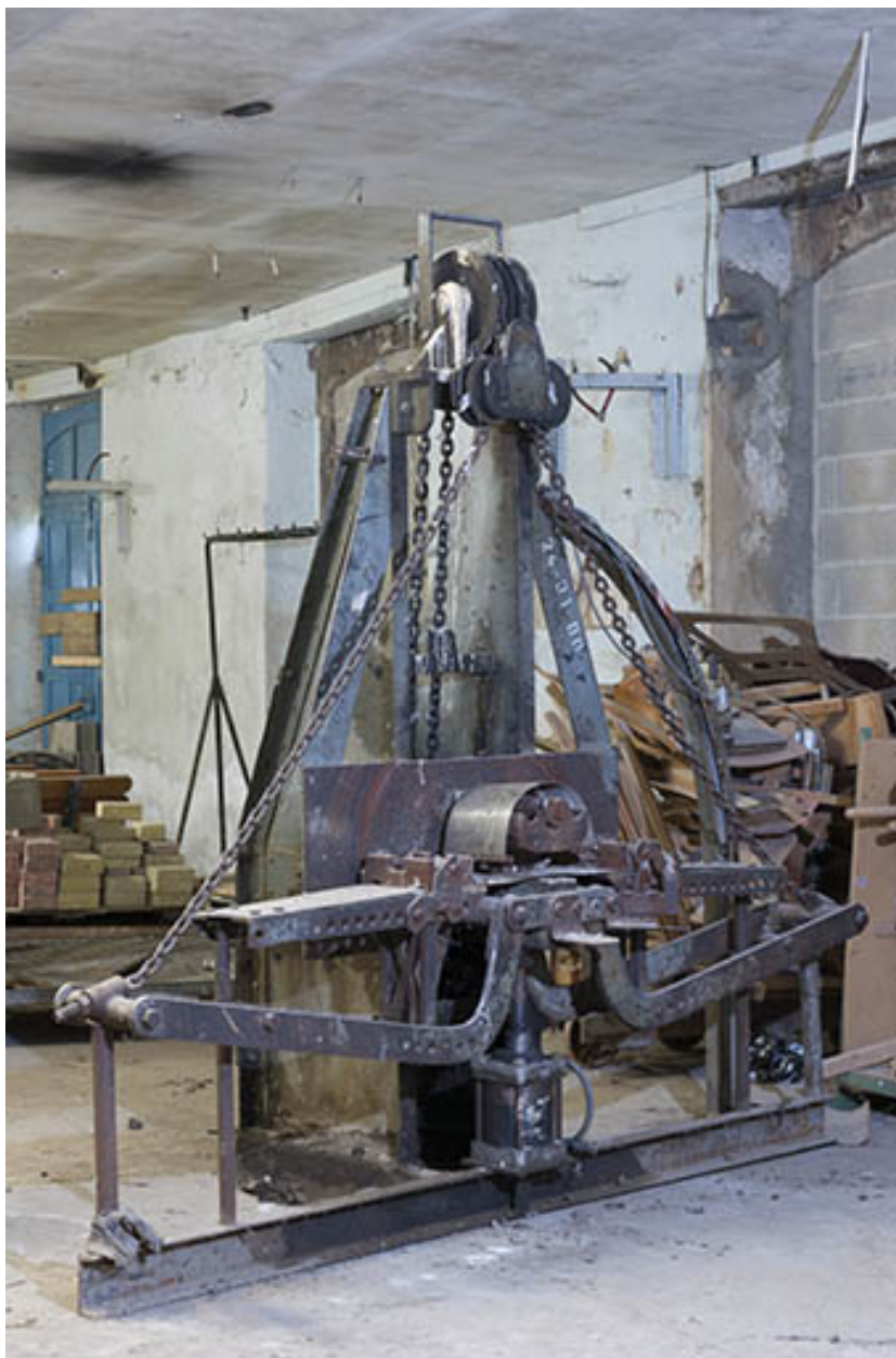
Usine de meubles (chaiserie Baumann), Colombier-Fontaine : cintreuse.
