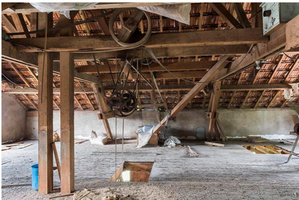
Vue de l'étage en surcroît, système de transmission par poulies et courroies et conduits fermés en bois
