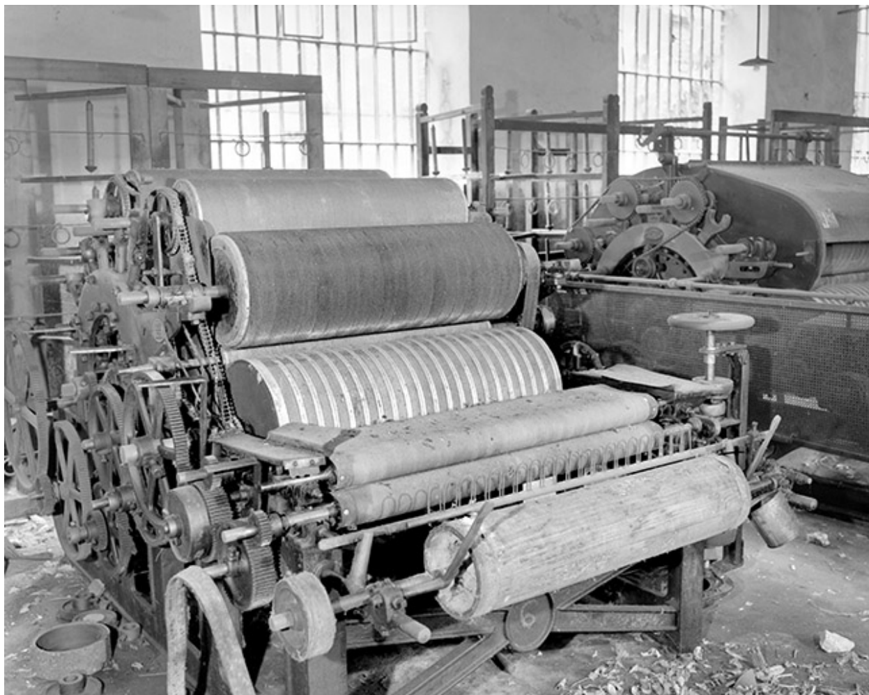
Face arrière vue de trois quarts gauche. Rouleau en bois, guide-fils, manchons frotteurs, cylindre volant et cylindres travailleurs.
