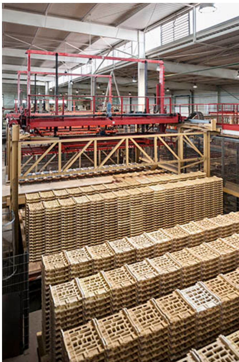
Unité de fabrication dite UL 5. Supports réfractaires pour la cuisson des tuiles.
