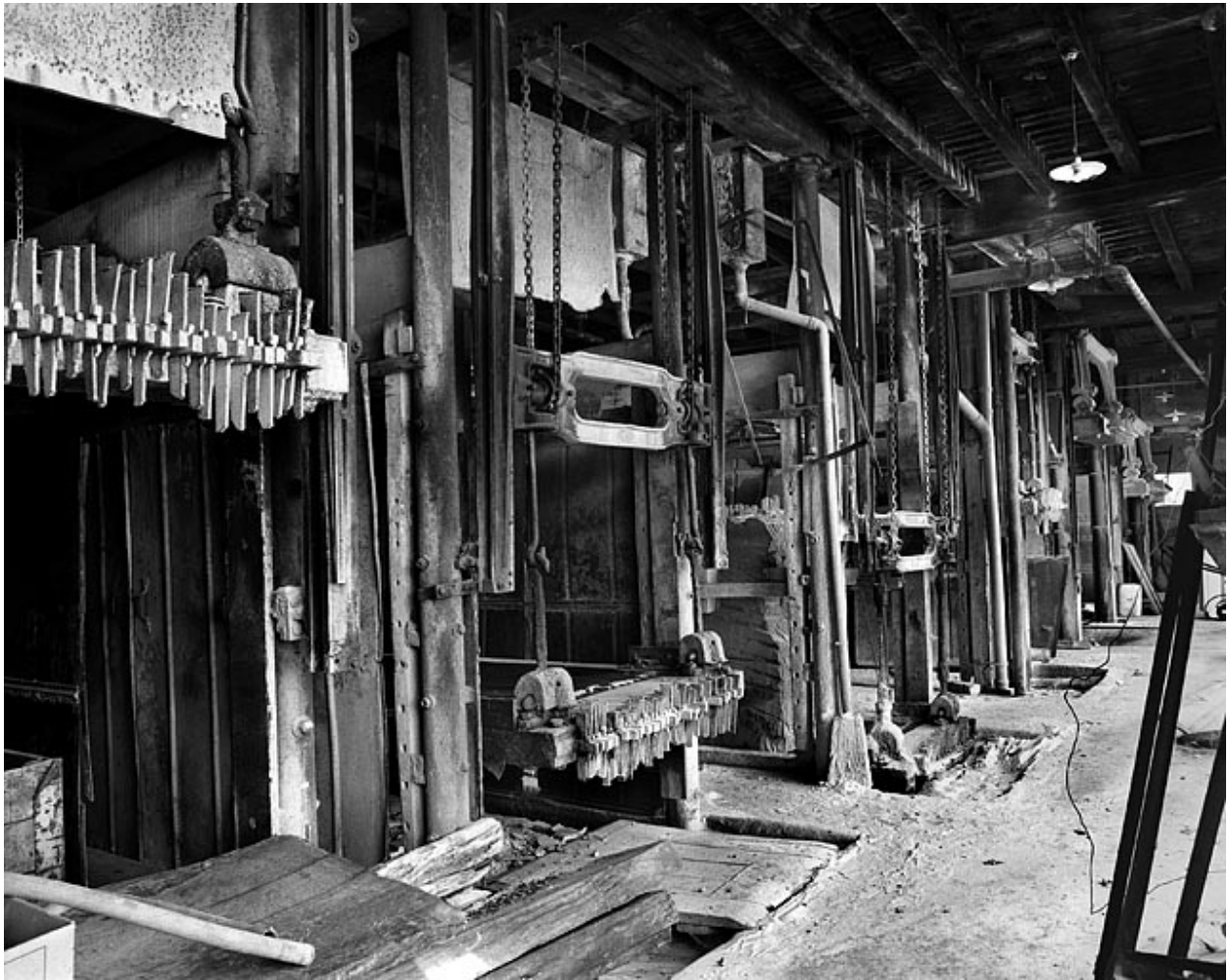
Usine de taille de matériaux de construction Célard, à Saint-Amour : vue d'ensemble des sept châssis de scie multilames.
