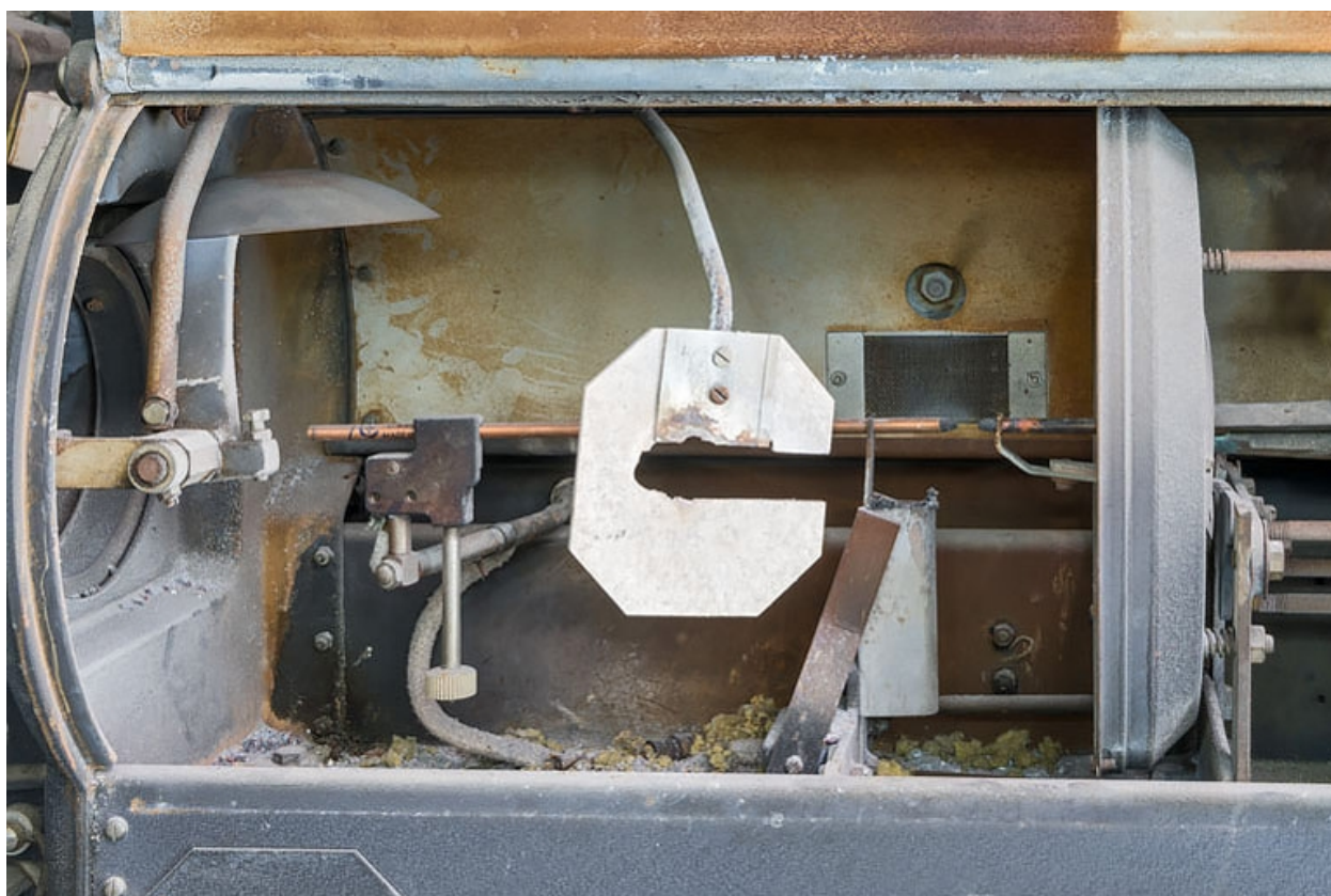
Projecteur côté jardin, lanterne : lampe à arc, en position de fonctionnement.
