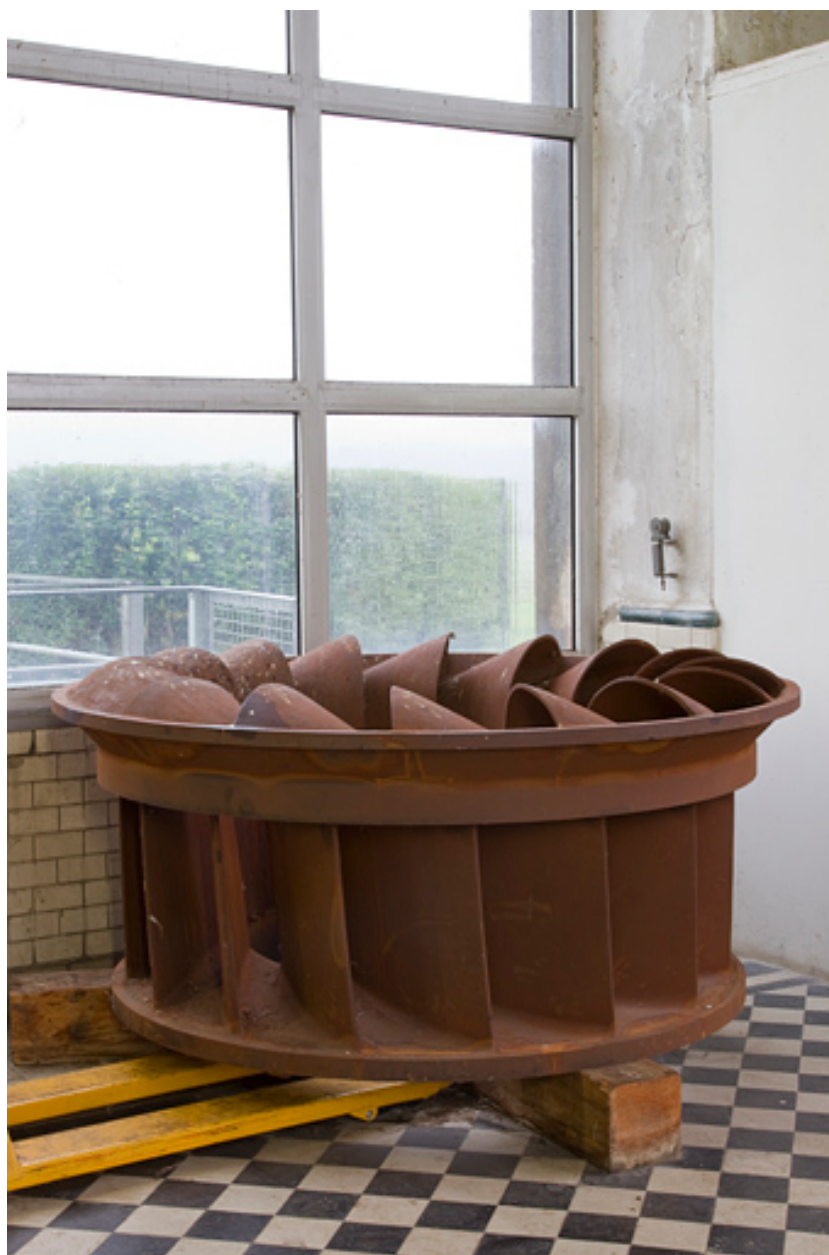
Centrale de la Prétière : turbine Francis déposée.
