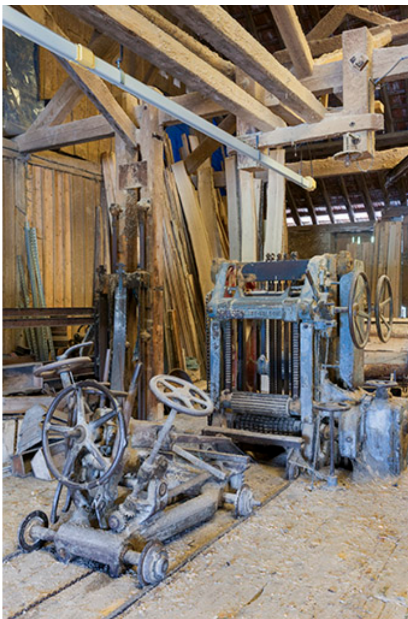
Châssis multilame Socolest (scierie Thiébaud, Labergement-Sainte-Marie).
