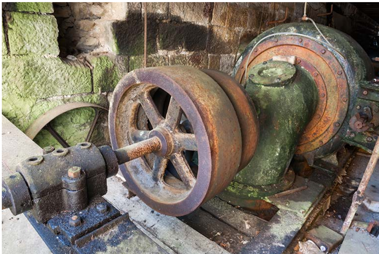
Turbine hydraulique (partie supérieure).
