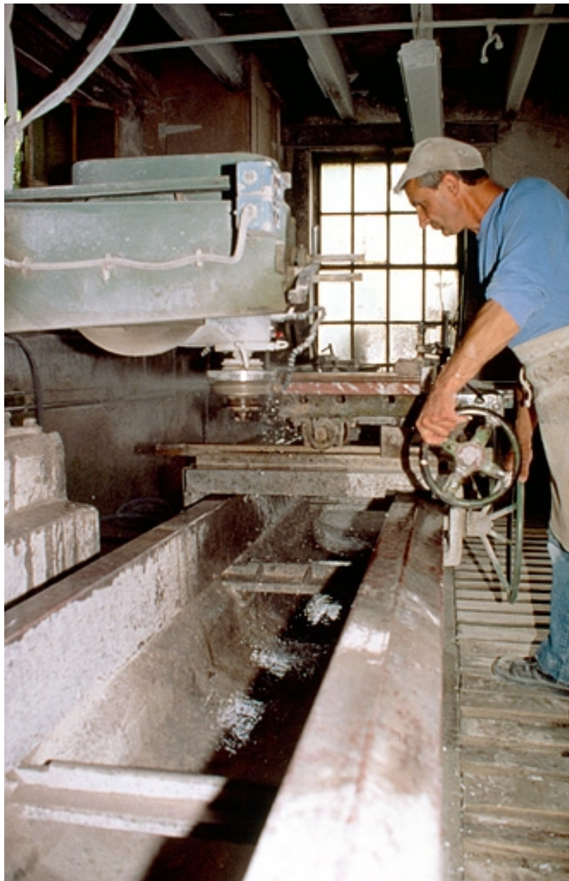
Usine de taille de matériaux de construction Yelmini Artaud, à Balanod : moulurage d'une plaque de marbre.
