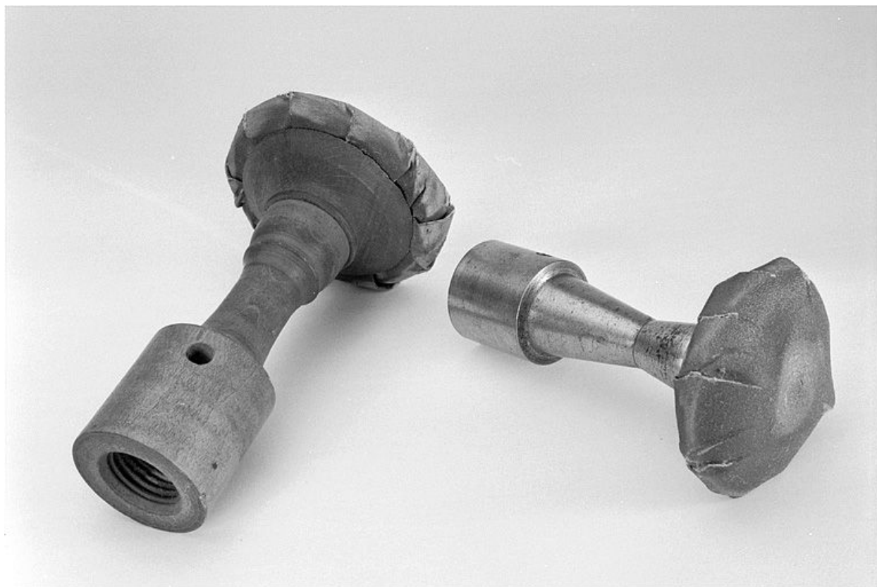
Détail de deux disques de polissage.
