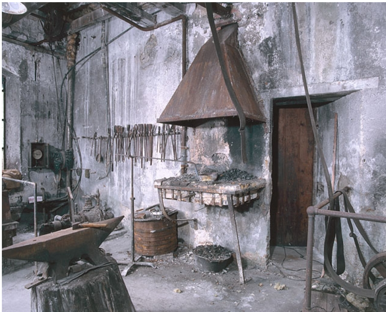
Poste de forge de l'atelier de mécanique.
