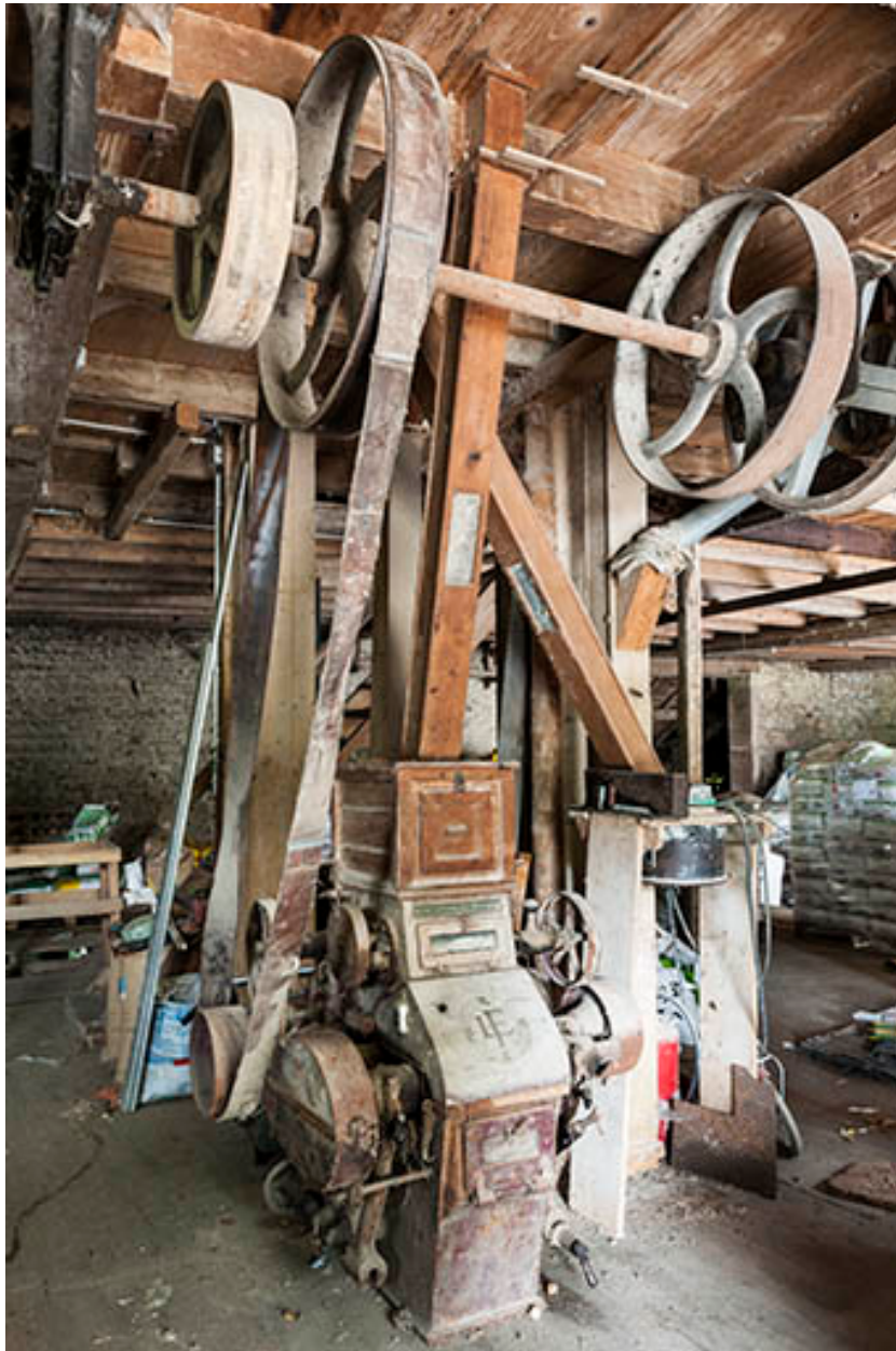
Rez-de-chaussée surélevé. Broyeur à cylindres Lacroix (Dole) et sa transmission par courroie.
