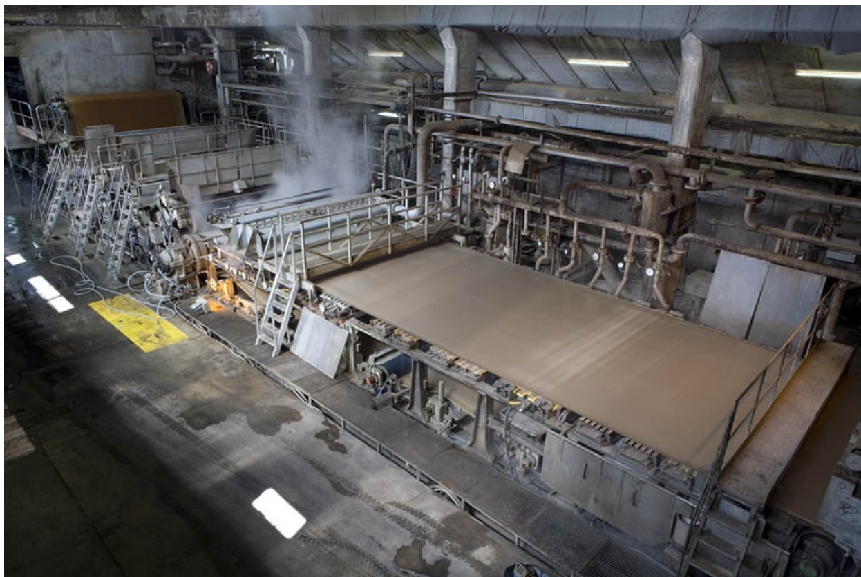
Machine à papier. La table de formation.
