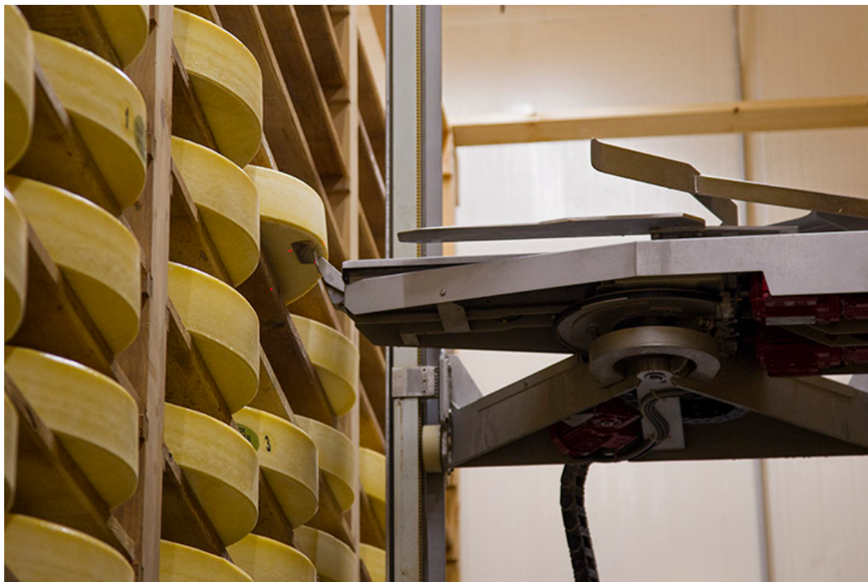
Affinage du comté : robot soulevant une meule.
