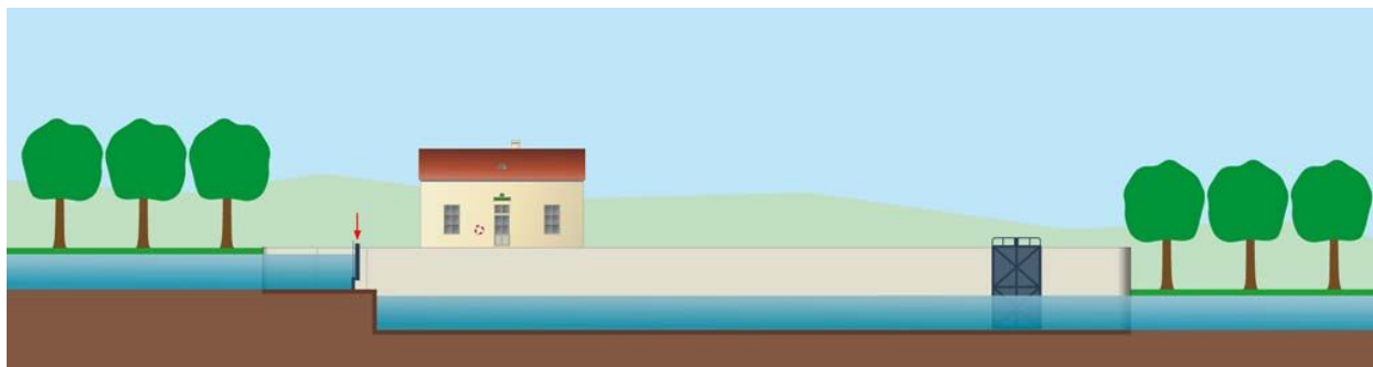
Schéma d'éclusage d'un bateau avalant, étape 11.
