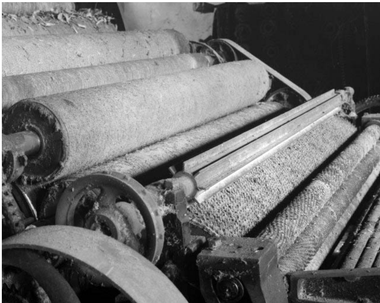
Détail du cylindre briseur. De droite à gauche, rouleaux alimentaires, cylindre briseur puis cylindres cardes de l'avant-train.
