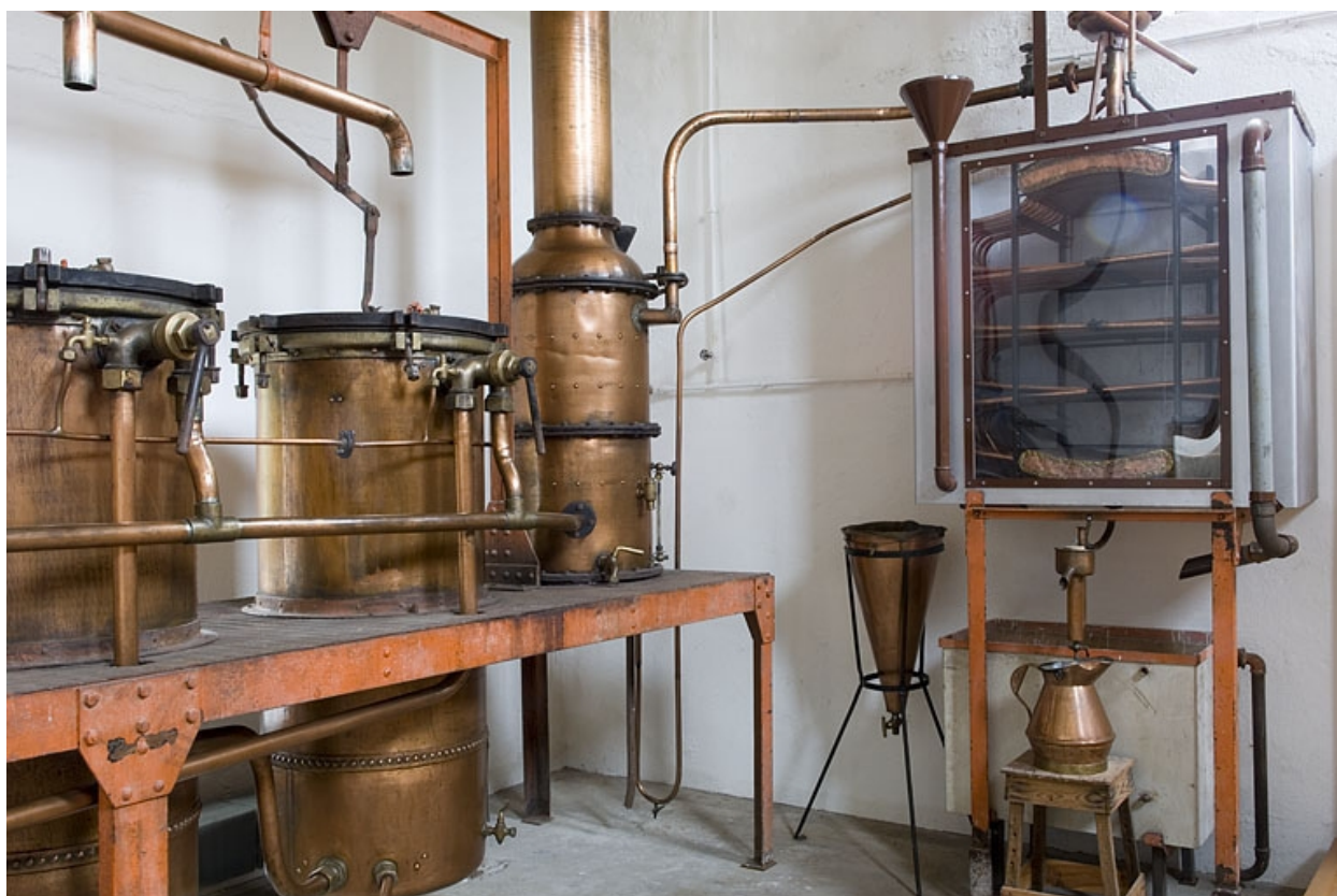
Salle de distillation. Alambics, colonne de rectification et réfrigérant.
