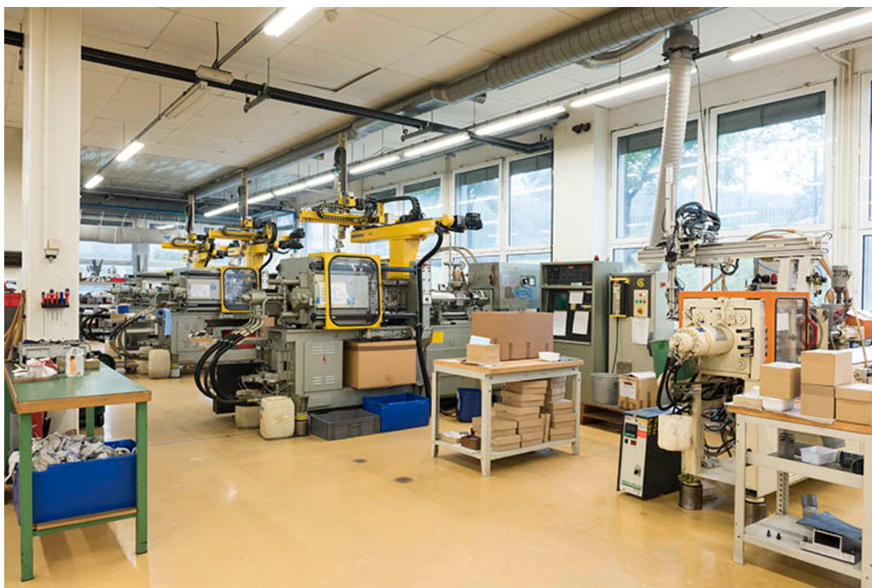
Atelier d'injection : les anciennes presses.
