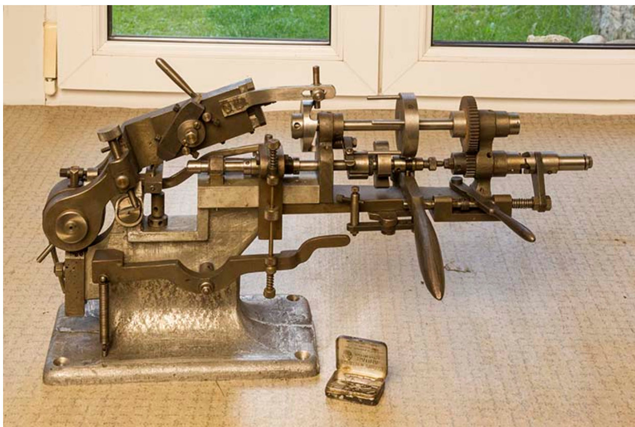
Machine à fabriquer les tire-nerfs pour dentiste (atelier de construction mécanique Berçot puis Roch, Maîche).
