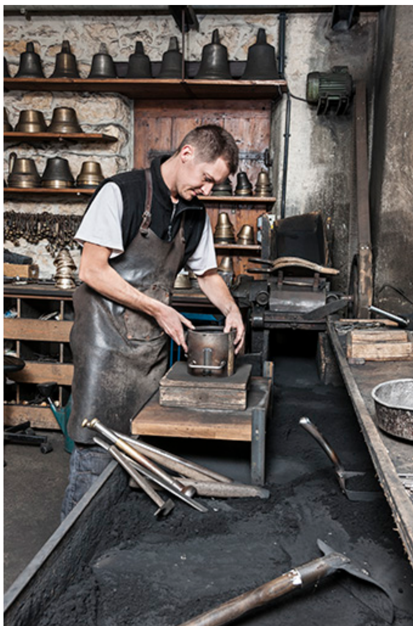
Moulage. Pose du châssis.
