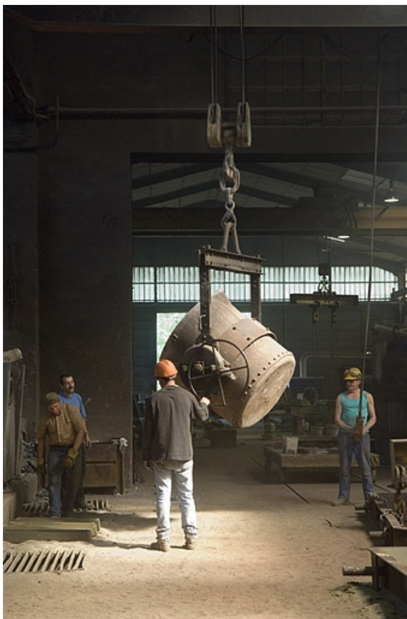
Préparation de la poche avant la coulée.
