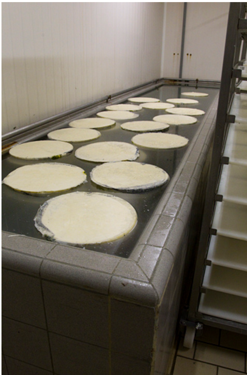
Fabrication du morbier : bac à saumure.
