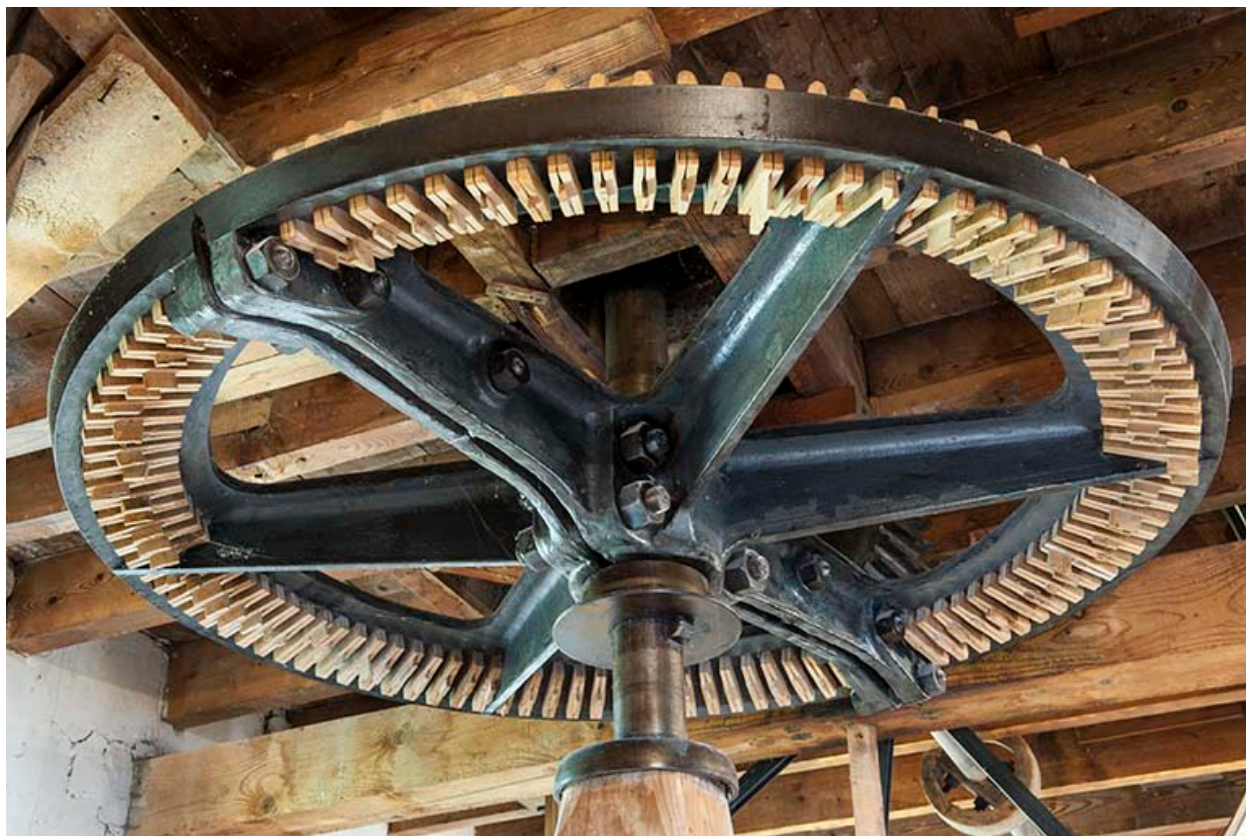
Roue métallique engrenée de dents (alluchons) en bois, appelée rouet.
