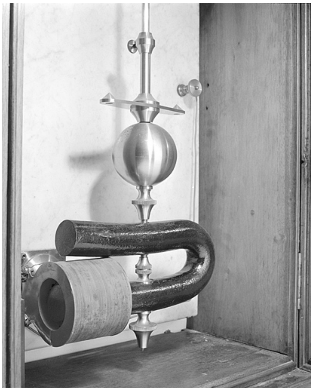
Le balancier (avec masse circulaire et aimant).
