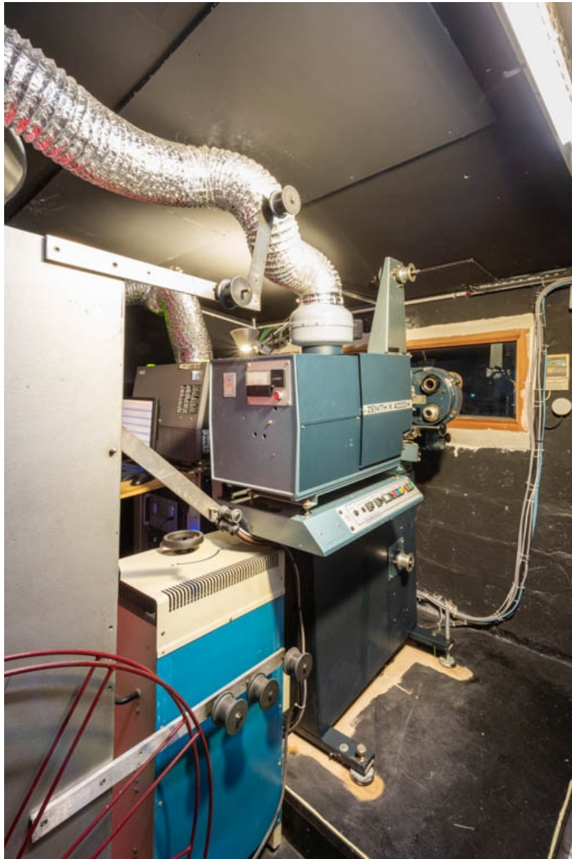
Salle 1 : cabine de projection. Projecteur 35 mm Zenith de la société milanaise Cinemeccanica au premier plan, projecteur numérique NEC à l'arrière-plan.
