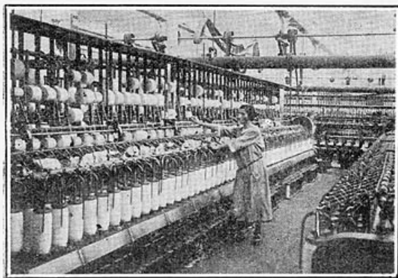
MÈTIERS A RETORDRE EN ACTION A L'USINE DU VAL-D'AJOL
