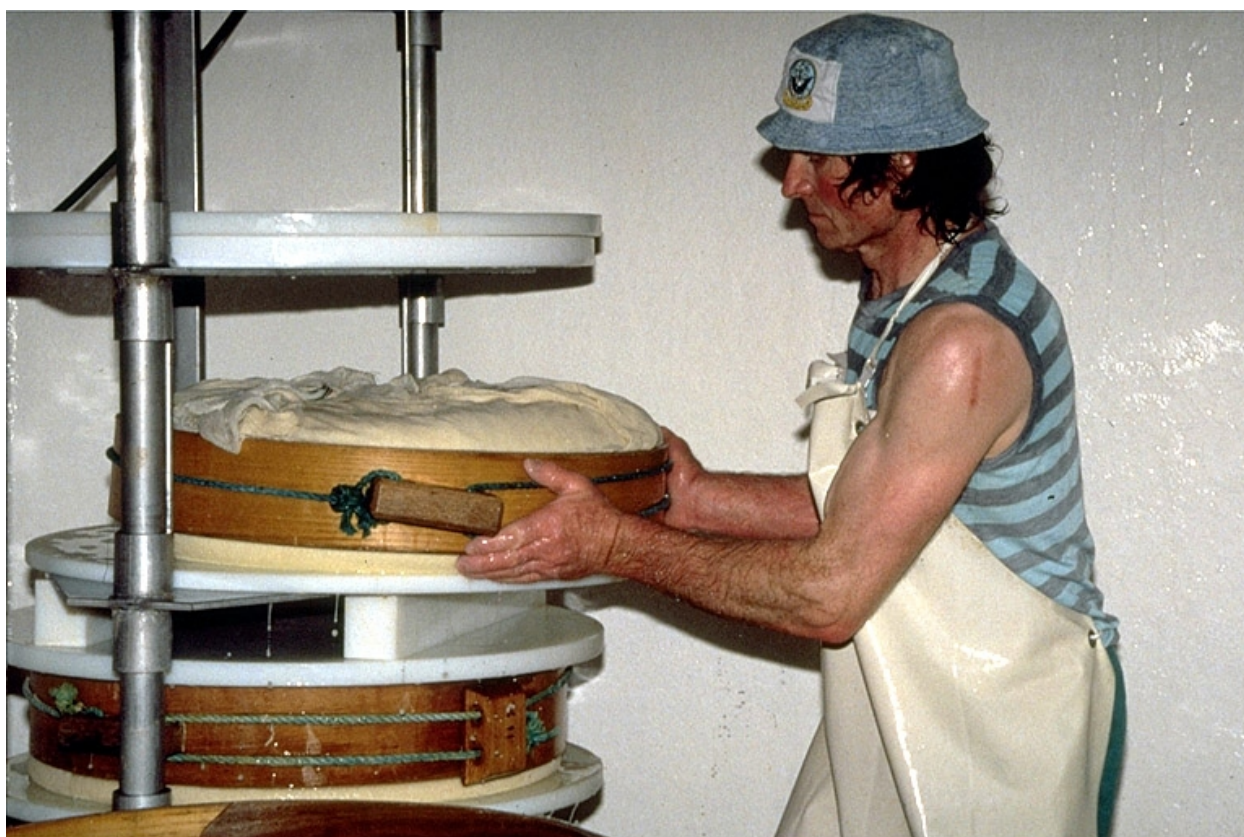
Chargement de la presse pneumatique.
