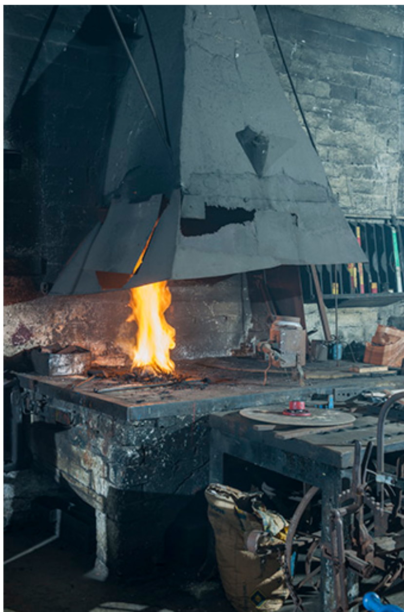
Forge : le foyer et le manteau en tôle.
