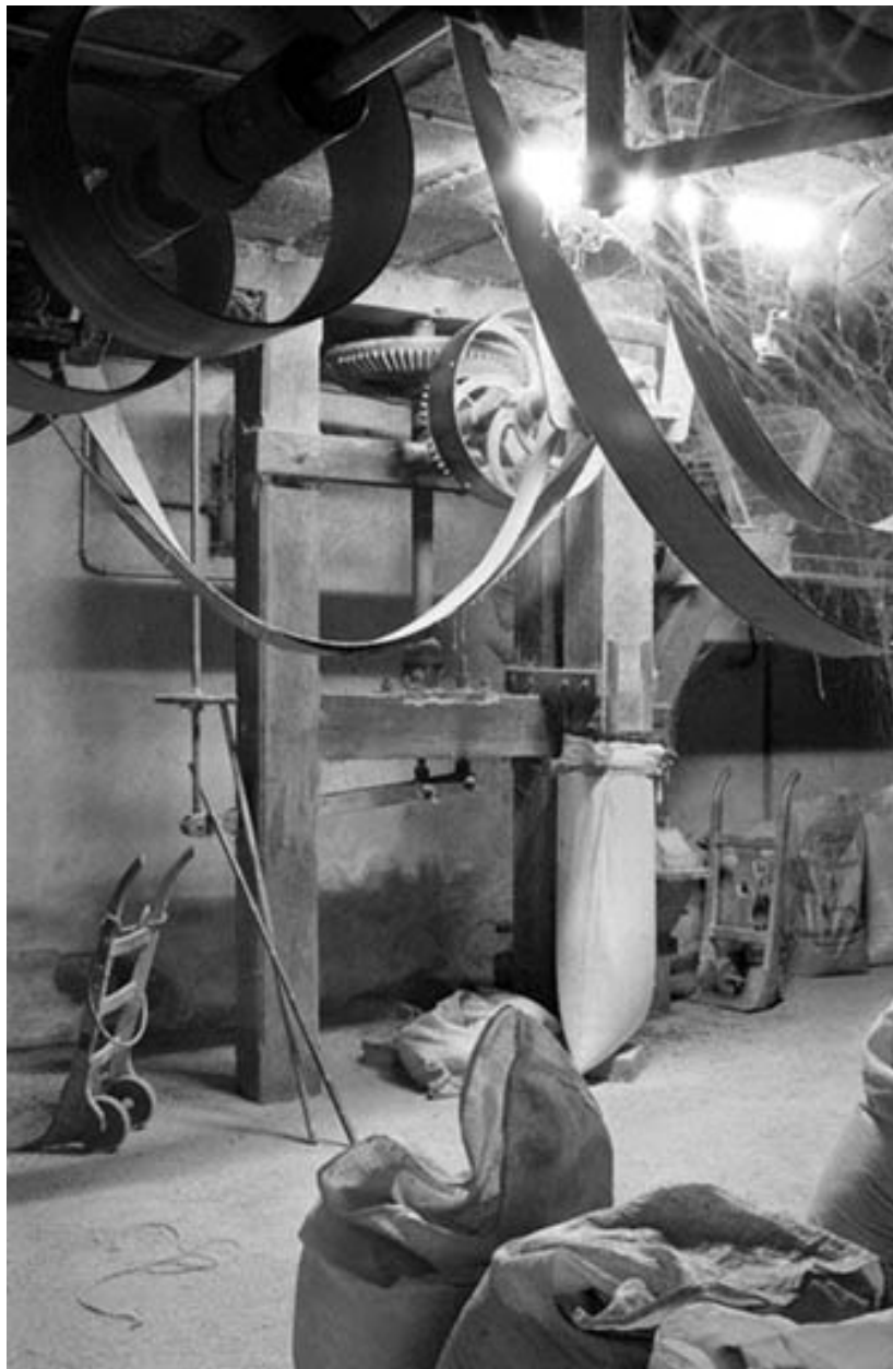
Minoterie (G), étage de soubassement : systèmes d'entrainement et d'allège d'une paire de meules.
