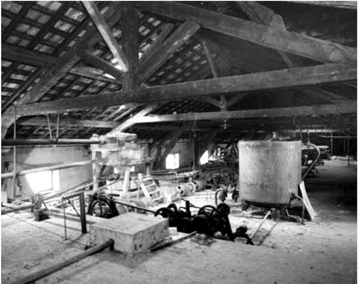
Cuve, système de distribution de la noria et systèmes de descente des châssis multilames dans le comble.
