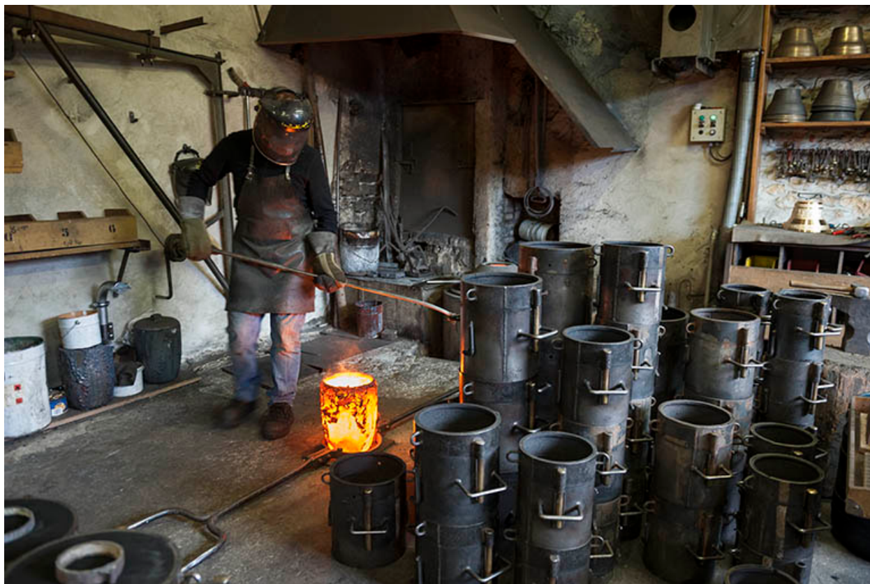
Creuset devant les châssis.
