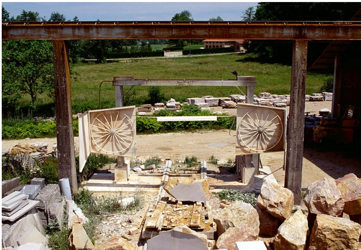
Usine de taille de matériaux de construction Carron, à Saint-Amour : scie à fil diamanté.
