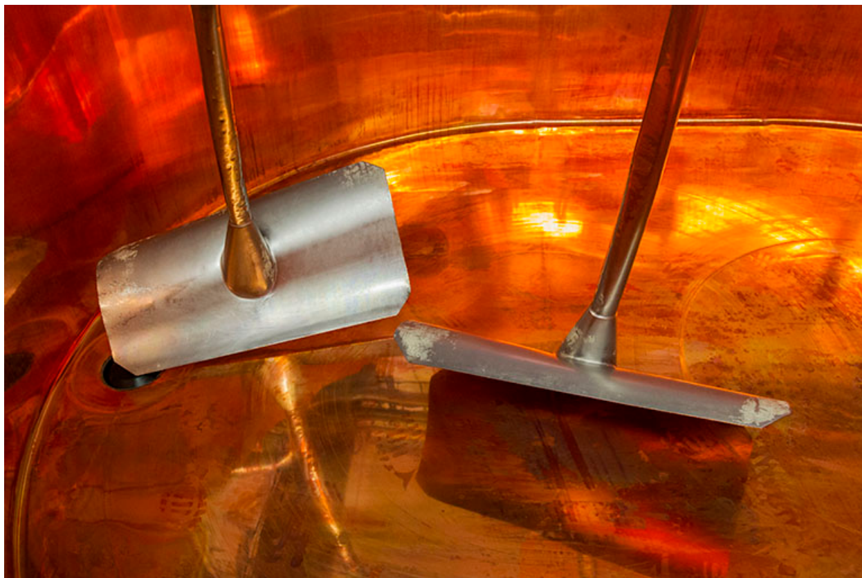
Cuve de fabrication standard : outils de brassage.
