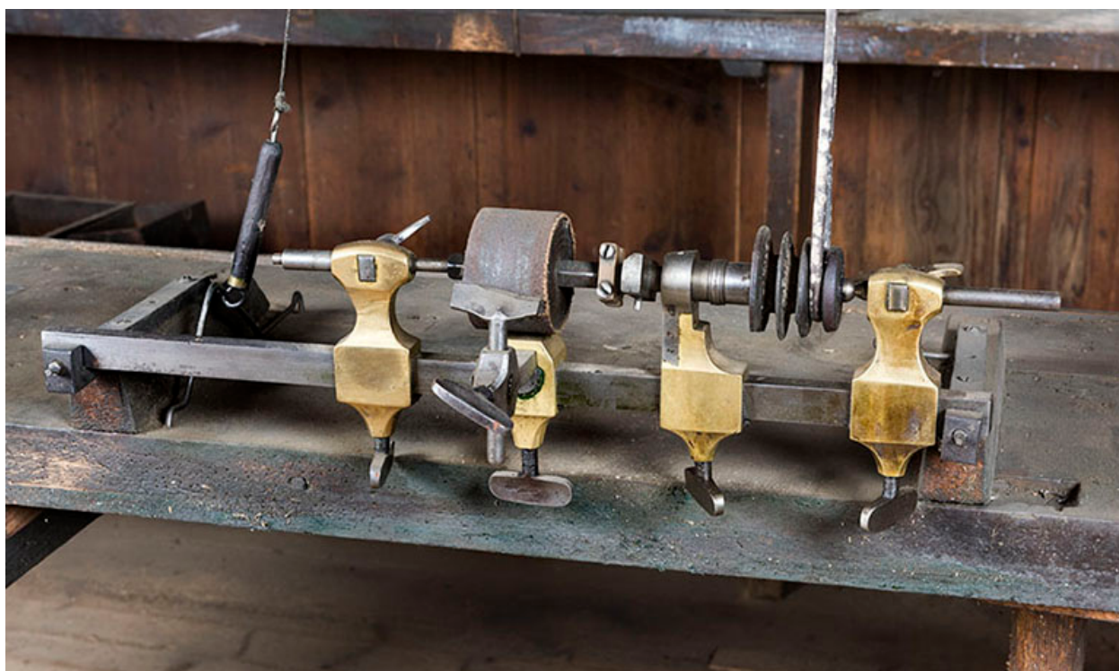
Tour à perche de la rangée centrale, équipé en machine à polir.
