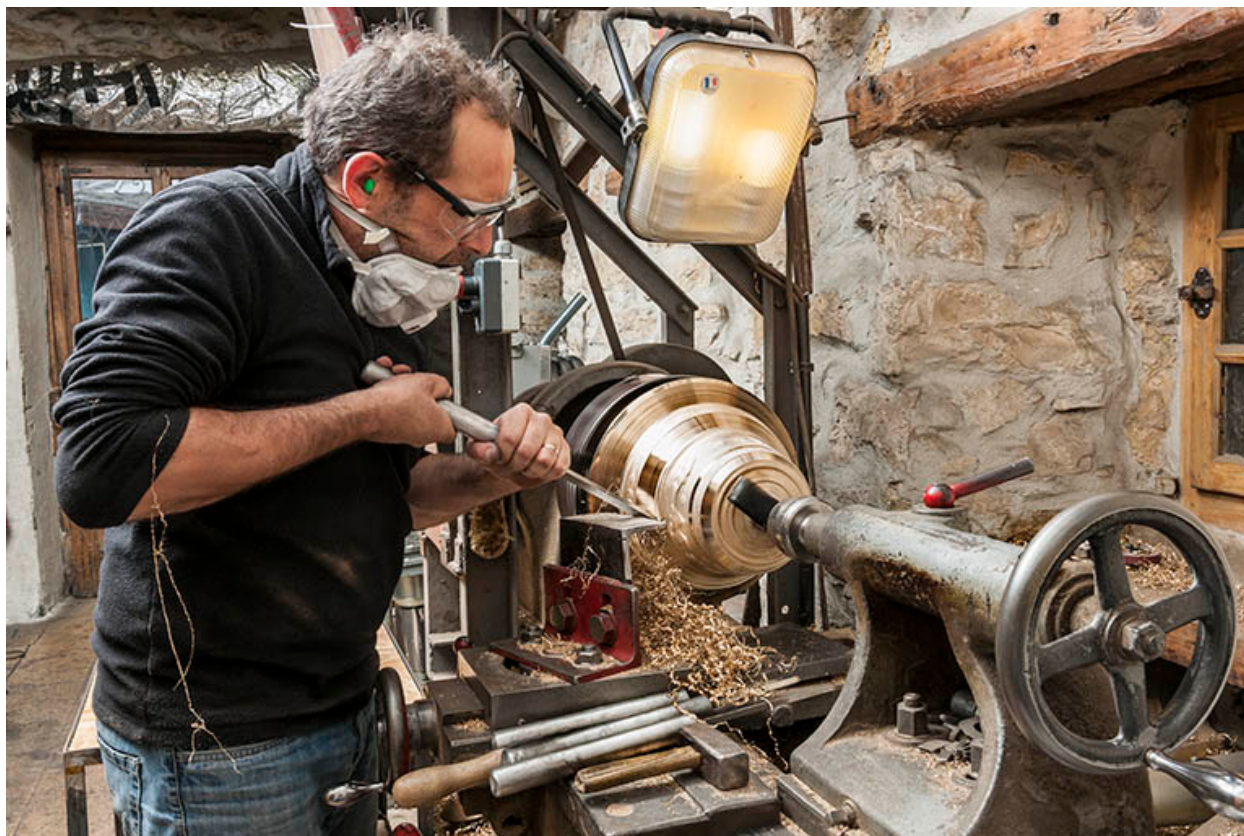
Tournage d'une cloche (2).
