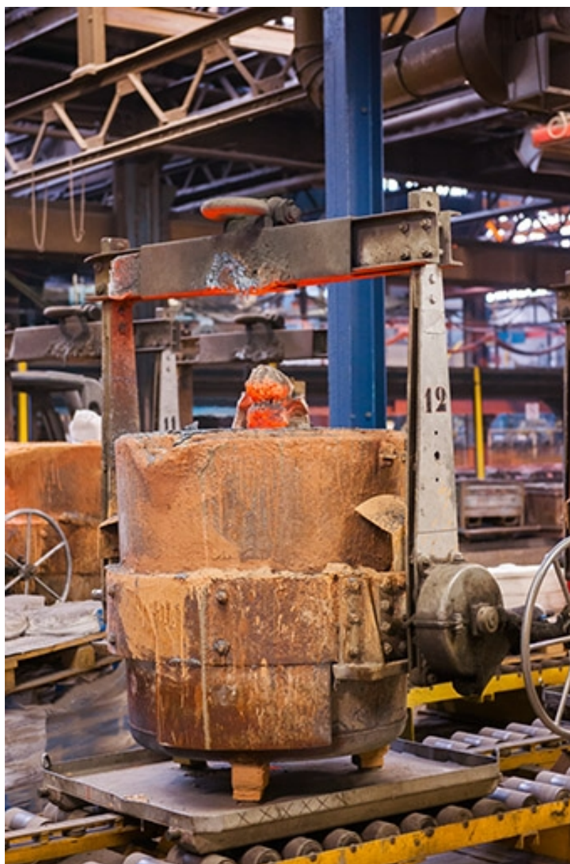
Poche de coulée avant réfection.
