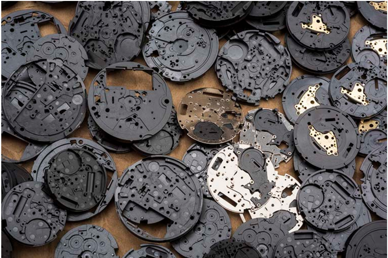
Composants fabriqués à l'usine : platines de montre.
