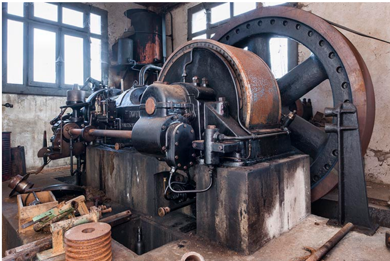
Moteur diesel Duvant.
