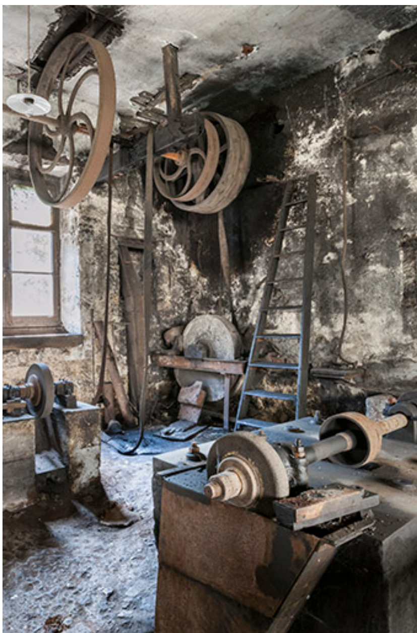
Atelier de mécanique. Transmission aérienne et polissoirs.
