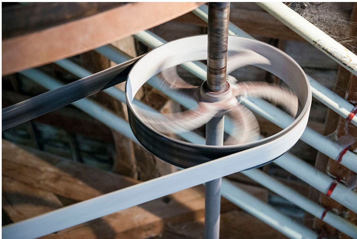
Troisième étage. Poulie et courroie du plansichter.
