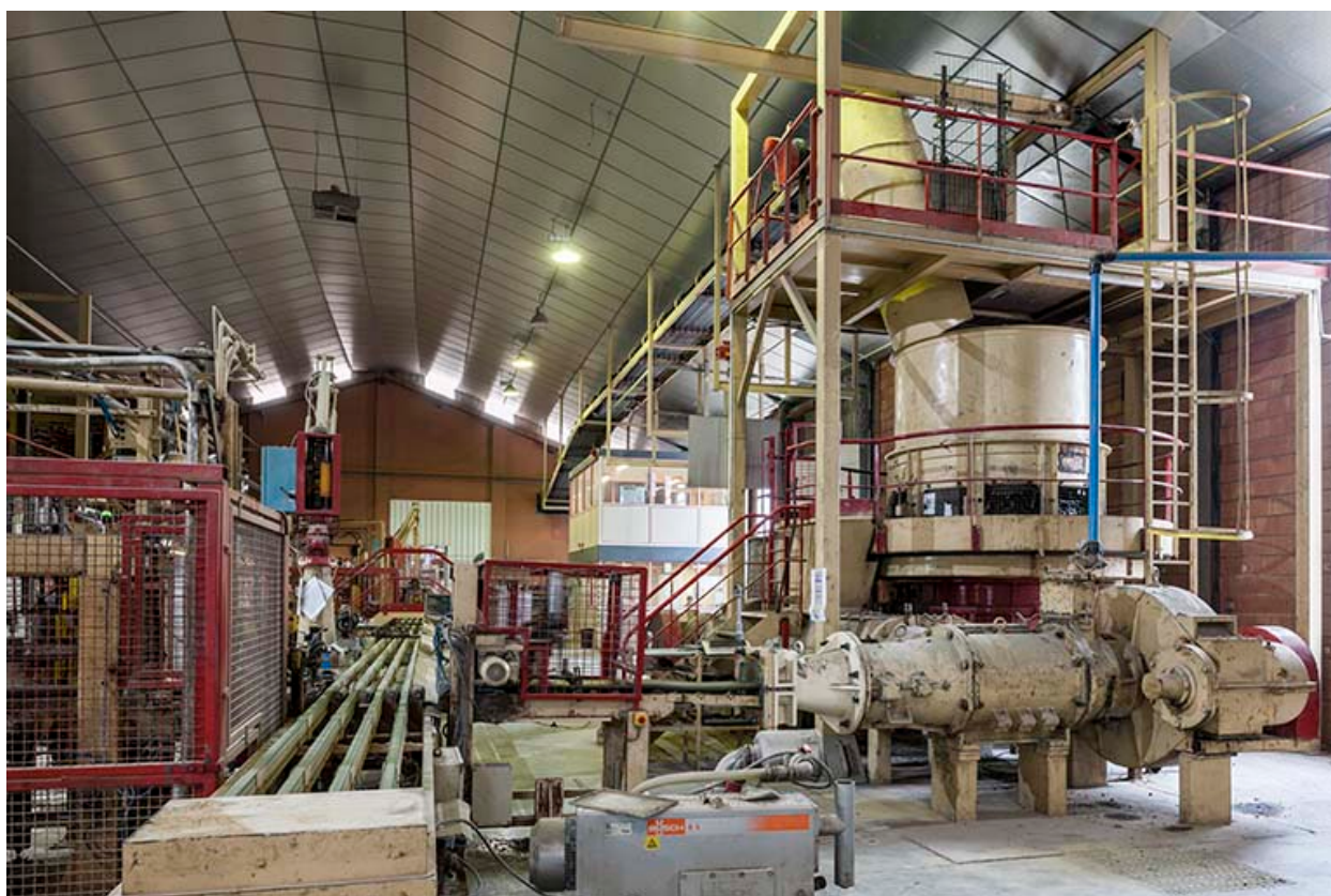
Unité de fabrication dite UL 3. Vue sur le malaxeur-râpeur et la mouleuse sous vide d'air.
