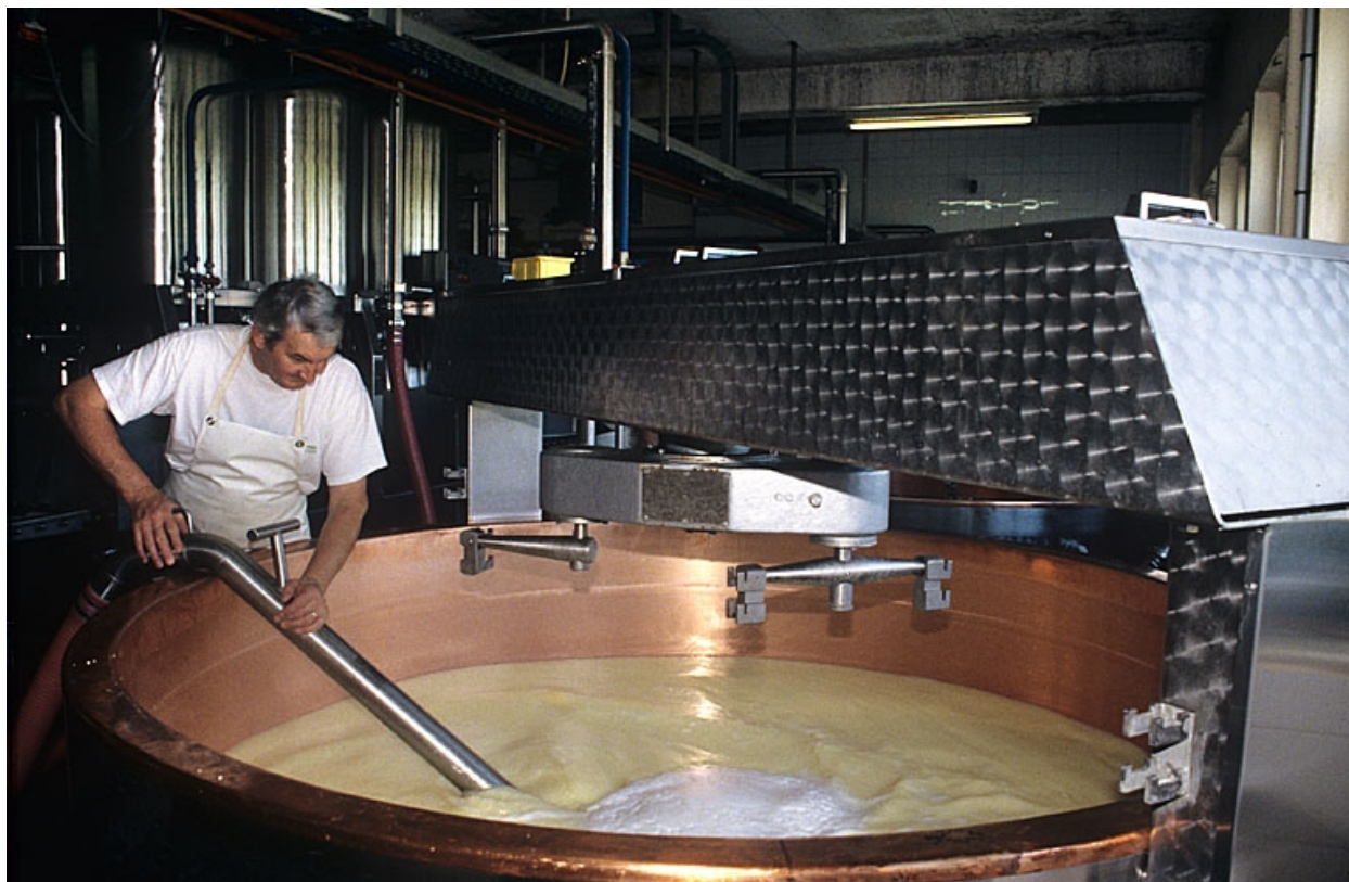
Soutirage sous vide.
