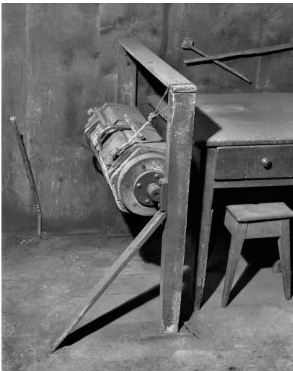
Intérieur : tonneau de polissage.
