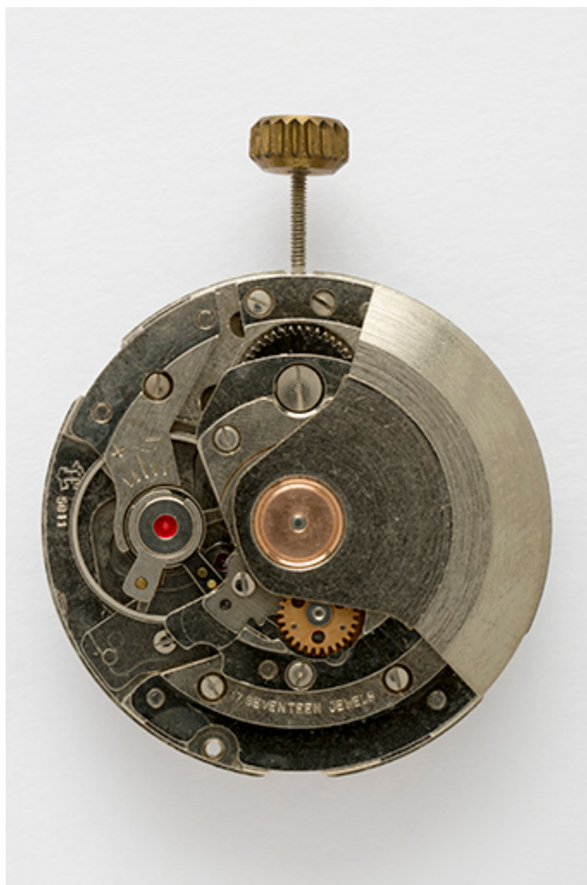
Mouvement France Ebauches FE 5611 : face côté ponts.
