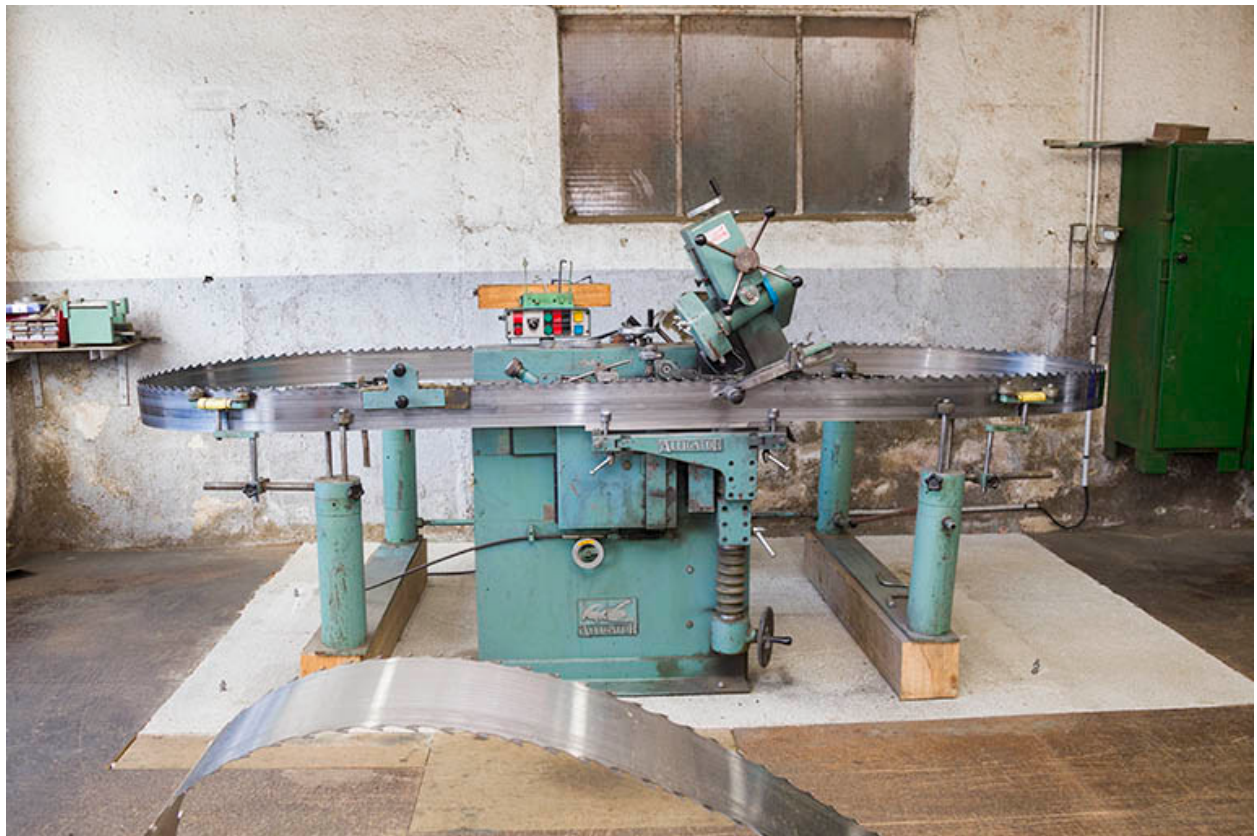
Atelier d'affûtage (K) : machine pour l'affûtage des lames de scie à ruban.
