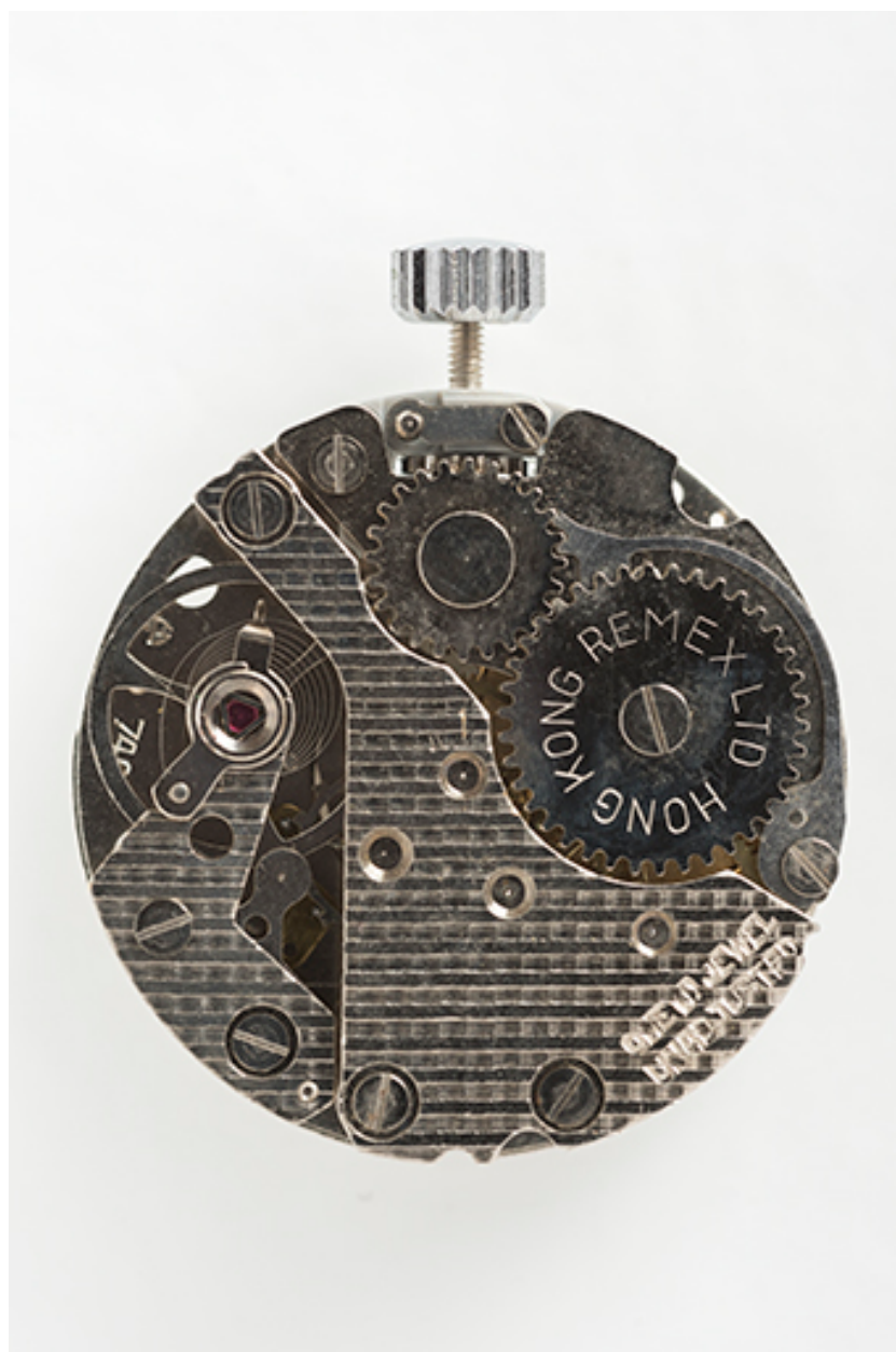
Mouvement Parrenin HP 740 : face côté ponts.
