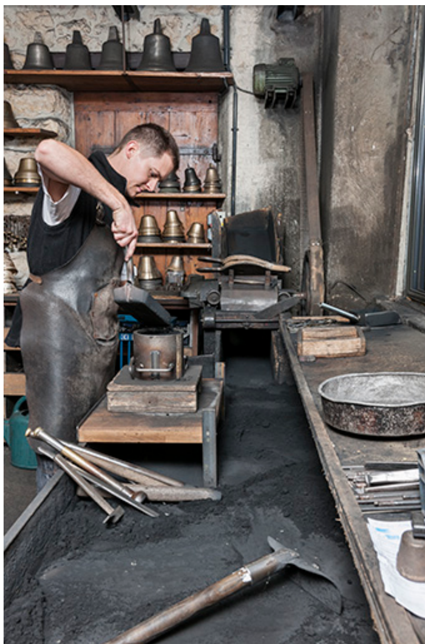
Moulage. Remplissage du châssis.
