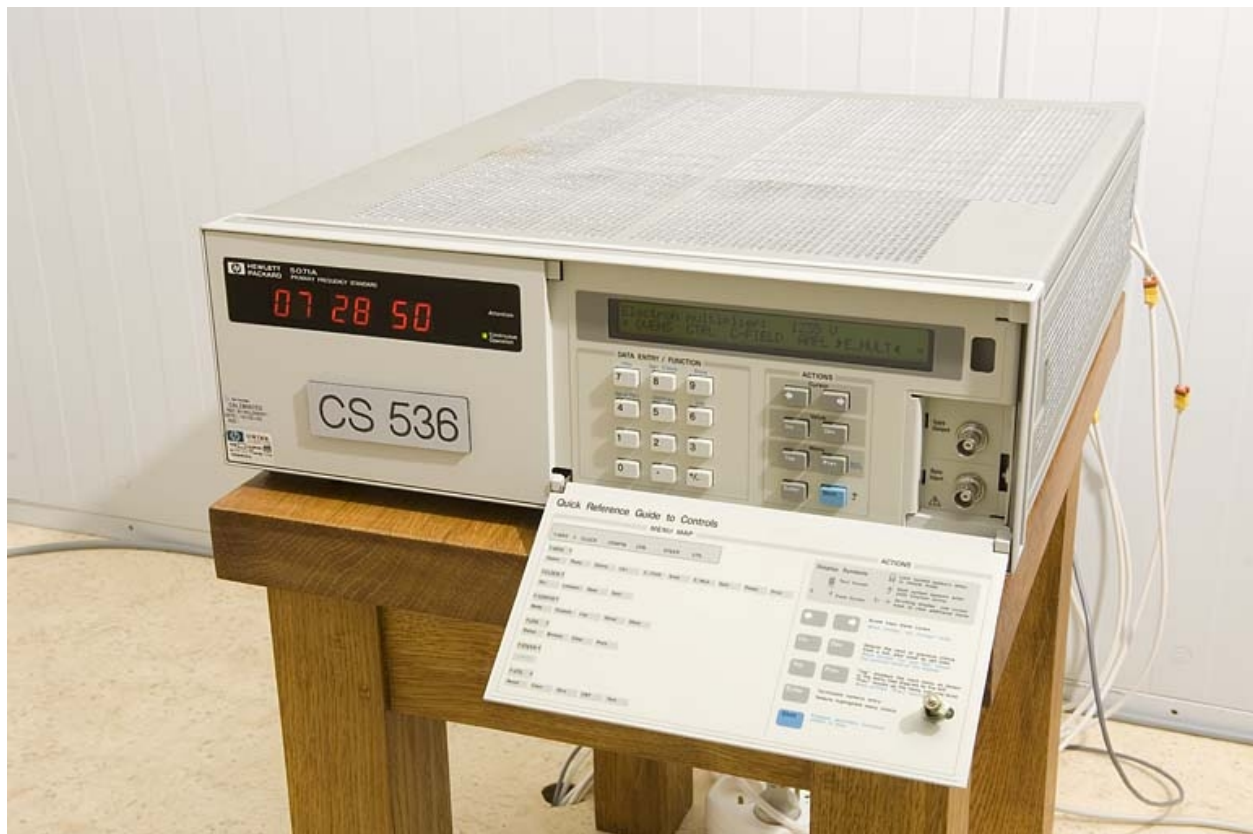
Horloge atomique Hewlett-Packard 5071A : vue d'ensemble.
